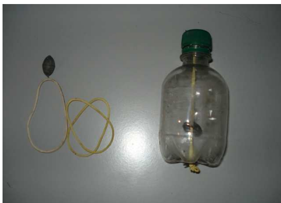
Fig. 1 – O peso deve ser fixado no meio do elástico que deve ser preso às extremidades do conjunto como mostra a figura.
